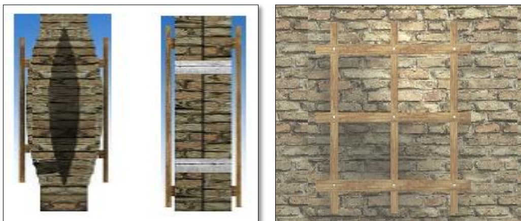
Figure 74 : pose de boutisse après réduction du bouffement par étaieement
