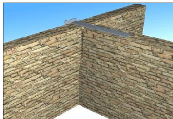
Figure 69: renforcement des deux murs en L par des fers plats en T figure 70: renforcement de la liaison des deux murs en T par des fers plat en T
