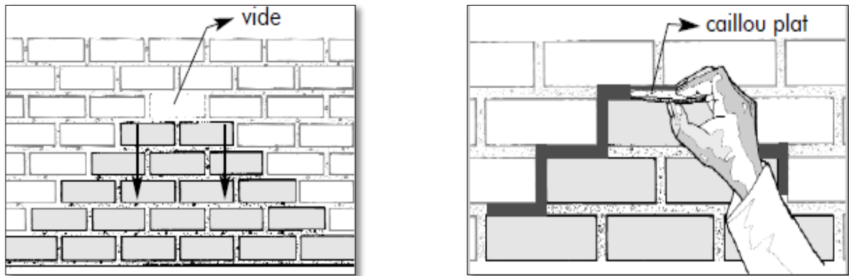
Figure59 : réparation finale des murs
