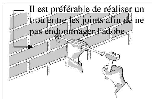
Figure 47 : mode de réparation des Mur pignon
