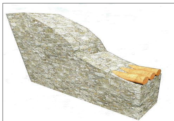
figure 14 : murs renforce pas trois rondin
