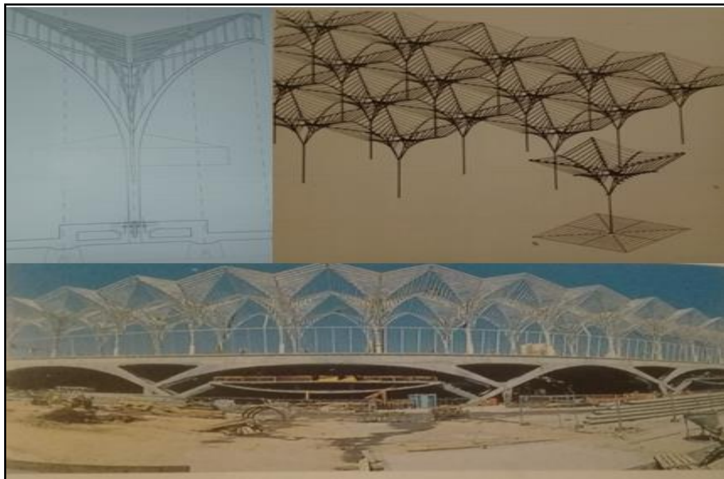
Figure n° :08:les poteaux arborescents gare ferroviaire et routière de Lisbonne Source : groupes moniteur, (2002)
