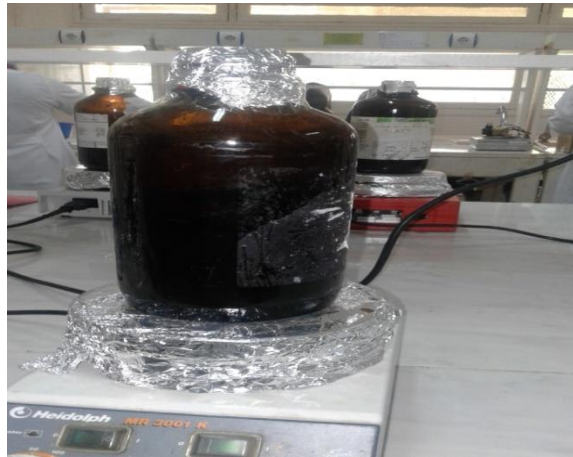
Figure 13 : Macération sous agitation magnétique.
