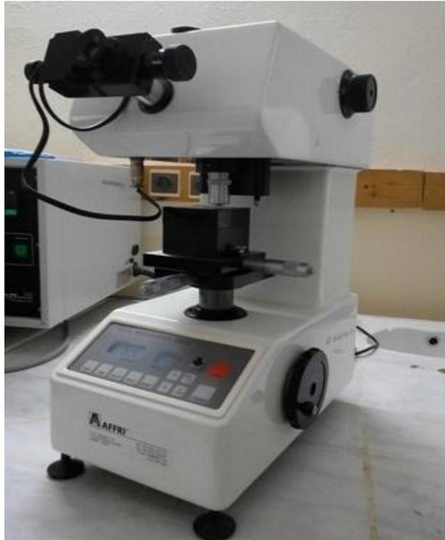
**Figure II.7 :** Dispositif de dureté Vickers.
