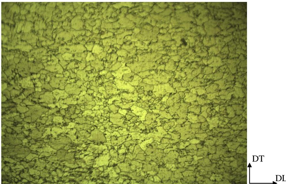
**Figure III.1** : Microstructure de la tôle observée par microscopie optique ( $G \approx 200X$ ).
