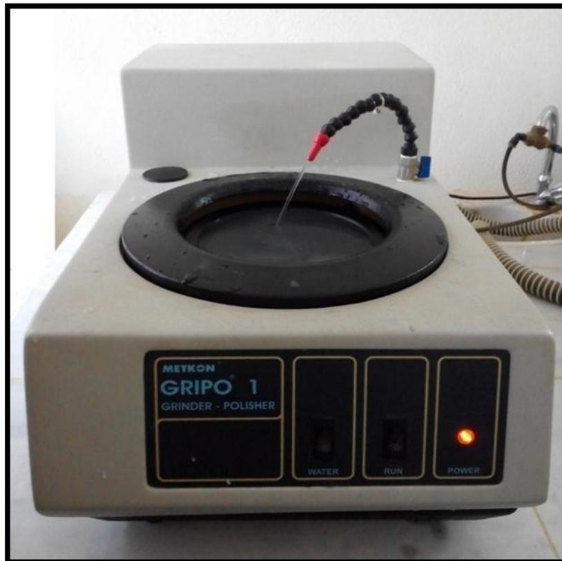
**Figure II.1 :** Machine de polissage mécanique utilisée pour la préparation d'échantillon.
