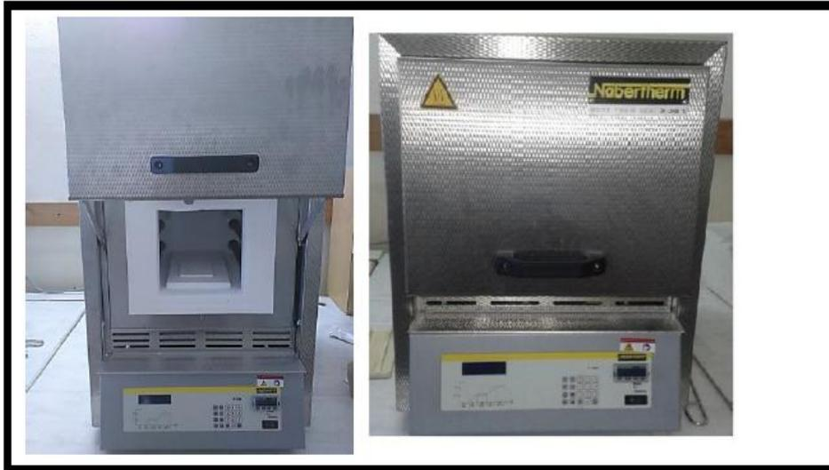
**Figure II.14 :** Four utilisé pour le recuit.
