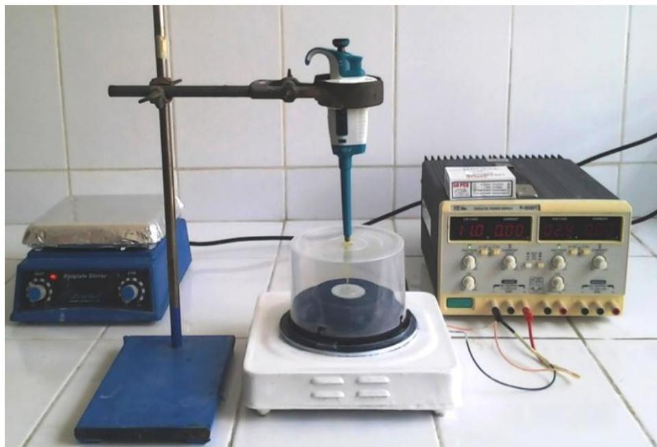
**Figure II.13.** *Dispositif de dépôt des couches minces par Spin-Coating.*
