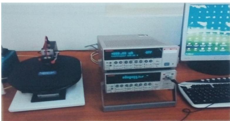
**Figure II.17 :** Appareil des quatre pointes (laboratoire de LEM Université de Jijel).
