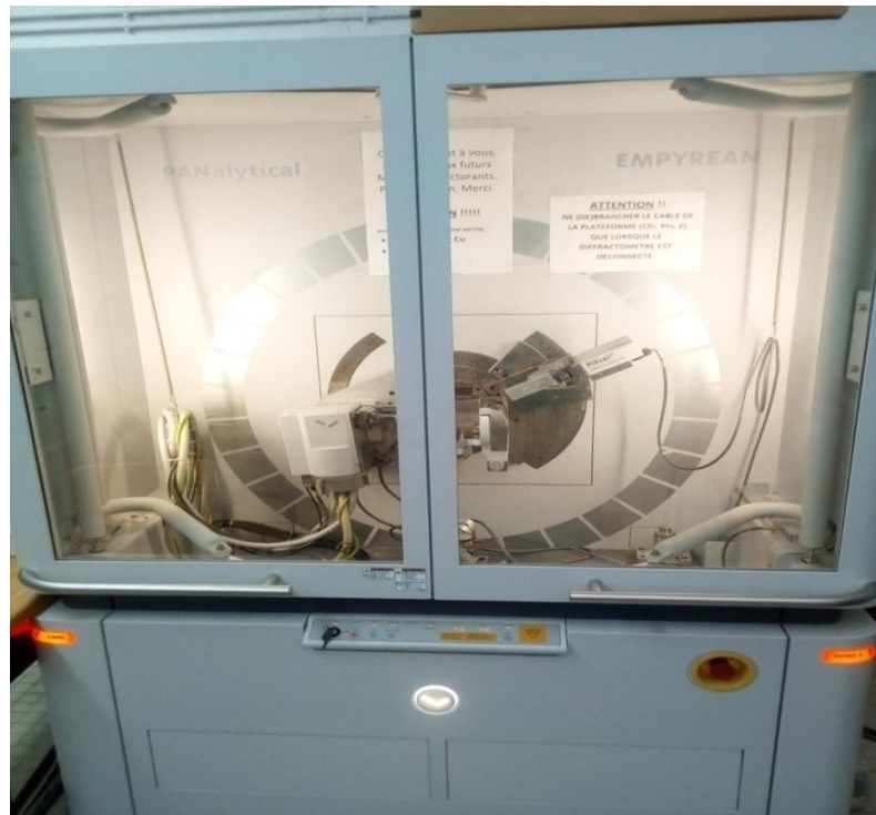
Figure 3.2: Image du diffractomètre disponible au laboratoire L.M.D.M (Univ. Constantine 1)
