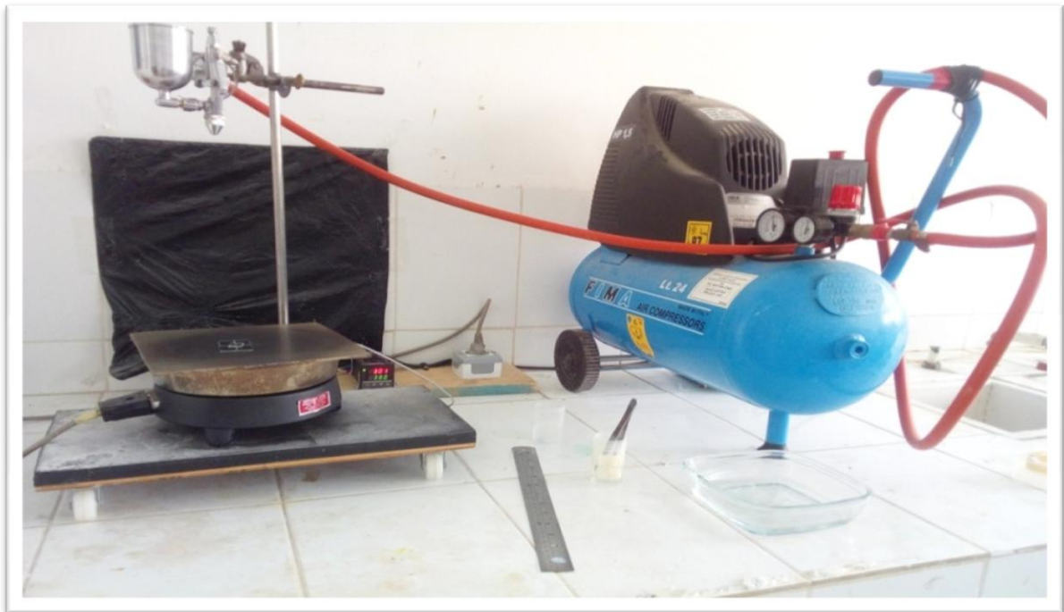
Figure 2. 3: Montage expérimental du système de spray pyrolyse pneumatique monté pour l'élaboration des couches minces de ZnO.
