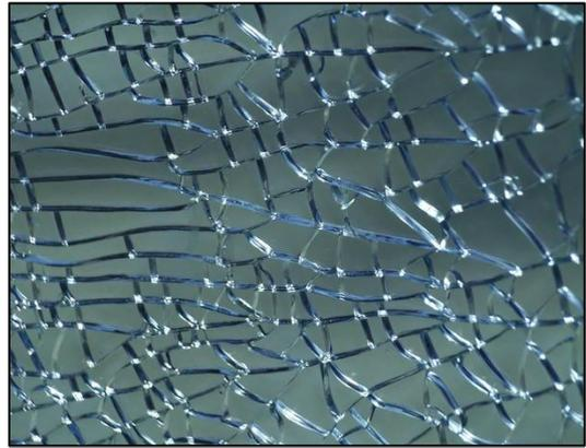
Figure.I.7. Le verre trempé thermiquement
