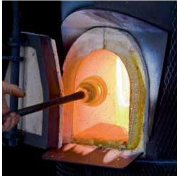
Figure.I.1. Verre en fusion est prélevé avec la canne
