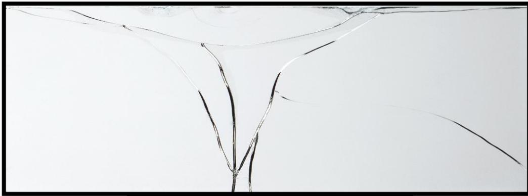
Figure.I.8. Schéma de casse d'un verre durci.
