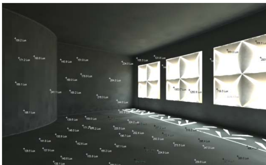
Figure 70 : les valeurs de niveau d'éclairément à 11 h façade avec dispositif ouvert à 45° Source : radiance.
