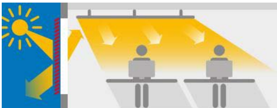
Figure 75 : schéma d'un plafond réfléchissant
