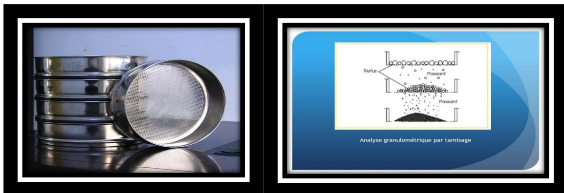
Figure.IV.3 : Essai d'analyse granulométrique par tamisage.
