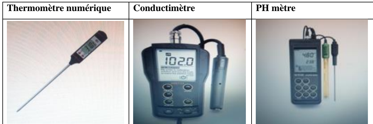
Figure 17 : Appareillage utilisé pour mesurer les paramètres physiques in-situ.
