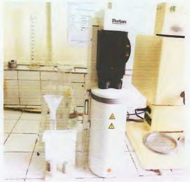
**Photo 11 : Appareil « falling number »**
