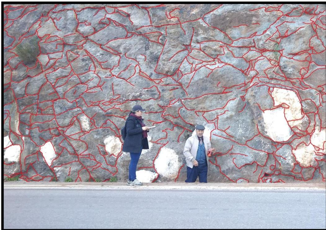
Figure.II.4. Différentes discontinuités dans le massif et l'intensité de fracturation (Yellas,2019)
