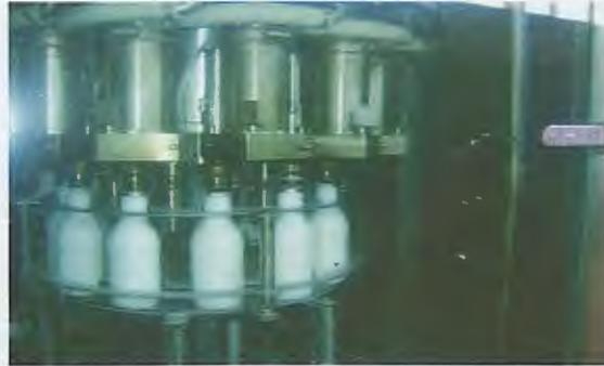
Figure 35. Remplissage des bouteilles.
