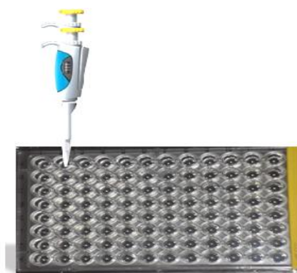
Figure 5. Image d'une microplaque de 96 puits en polystyrène
