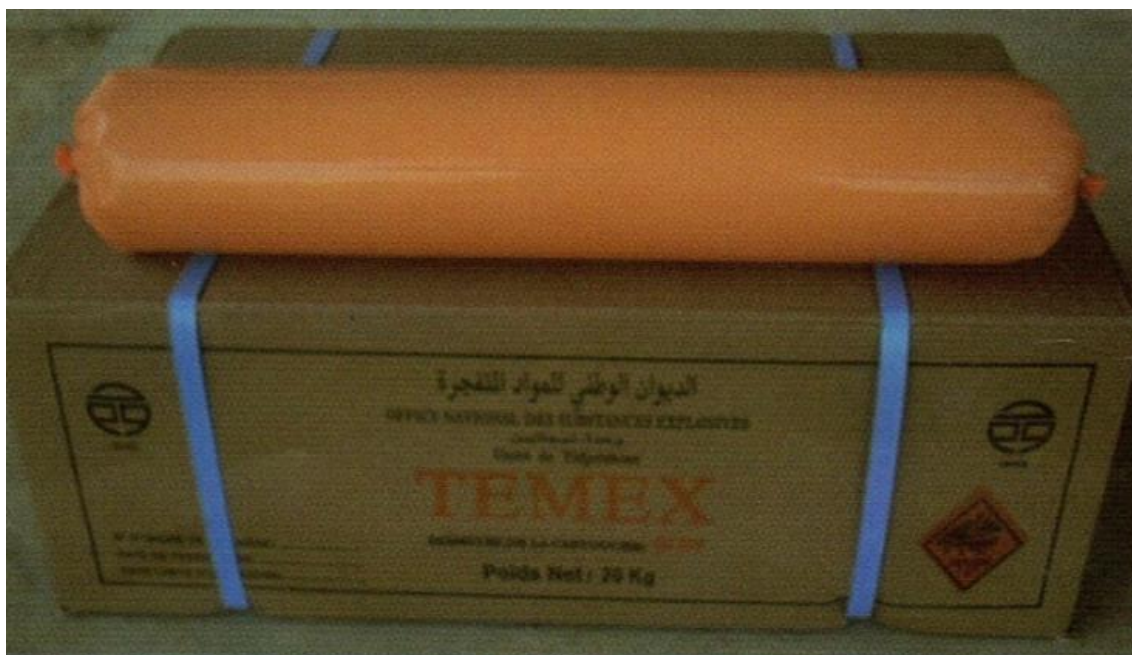
Figure12 : Image photographique montrant l'explosif de type TEMEX.
