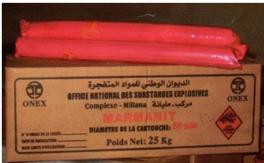
Figure11 : Image photographique montrant les cartouches de la Marmanit
