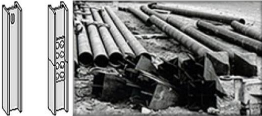
Figure I-28 Pieux en métalliques.
