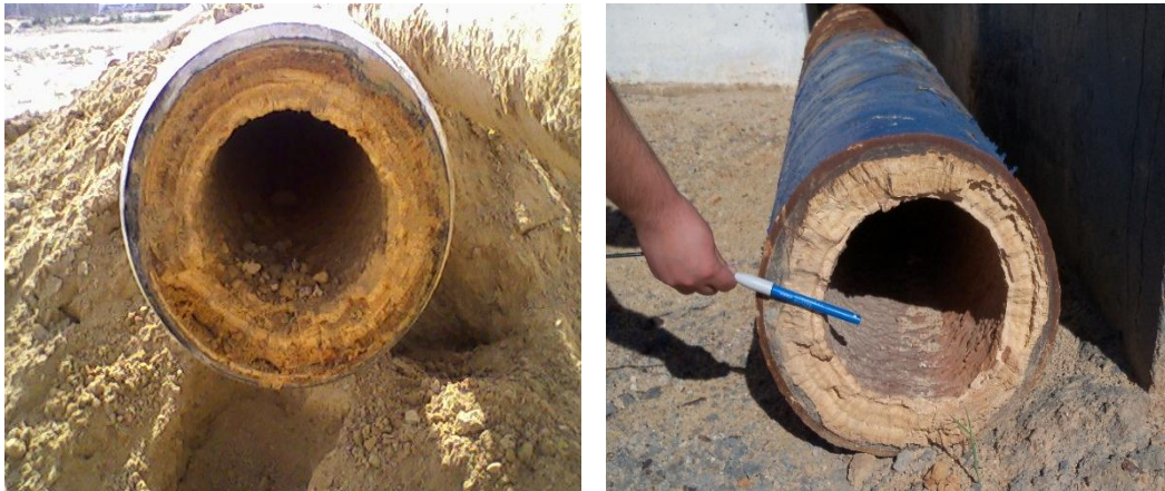
Fig. 35: Conséquence de l'entartrage des installations à Touggourt.
