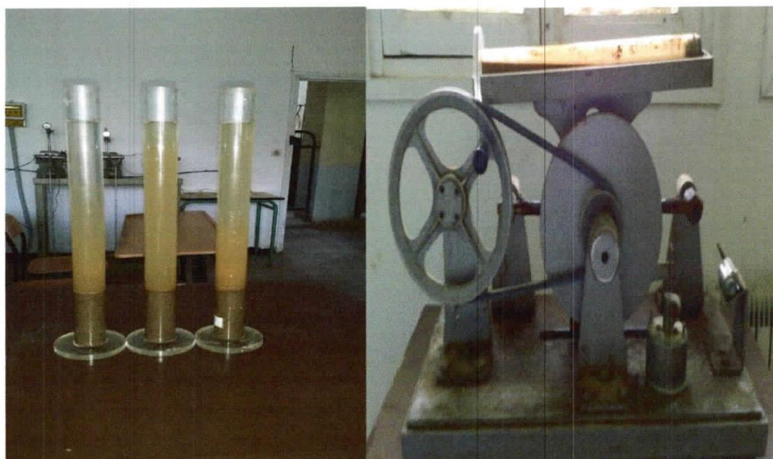
Figure III.4: échantillon équivalent de sable.
