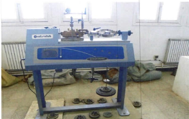
**Figure IV.5:** L'appareil de cisaillement.
