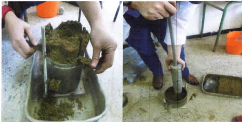
Figure IV.2: L'opération de l'essai Proctor.
