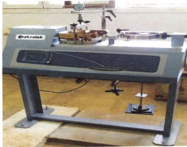
Figure (II.16) : L'appareil de cisaillement à la boîte
