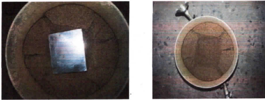
Figure (IV.35) : Déformation de l'échantillon (cas de la semelle carrée).
