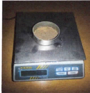
Figure (II.6) : Mesure le poids de sable sèche.
