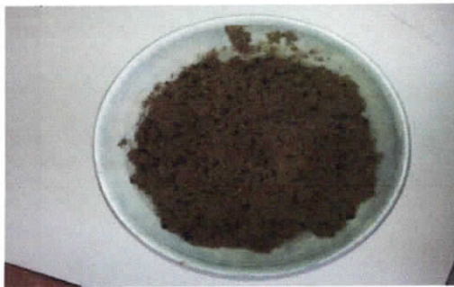
Figure (III.3) : Echantillon sable et granulats de pneu.
