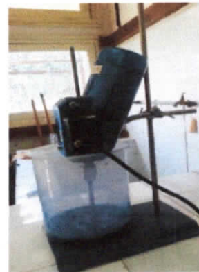
Figure (II.3) : Essai au bleu de méthylène.
