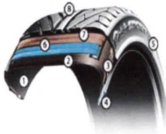
Figure (I.13) : Coupe transversale d'un pneu.
