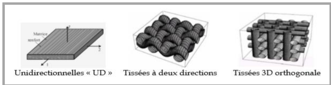
Figure (I.9) : structures des matériaux composites monocouches [4].
