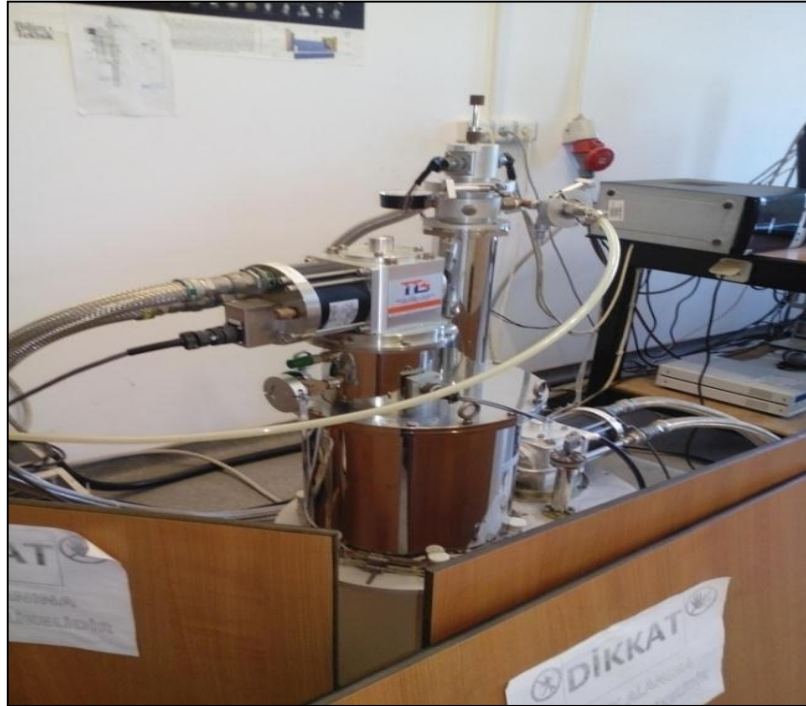
Fig. III.11 : Photographie d'un Cryostat (laboratoire de supraconductivité de l'université de Bolu, Turquie).
