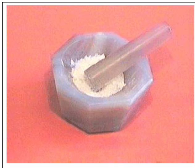
Fig. III.2. Mortier et pilon en agate utilisés dans le broyage manuel.
