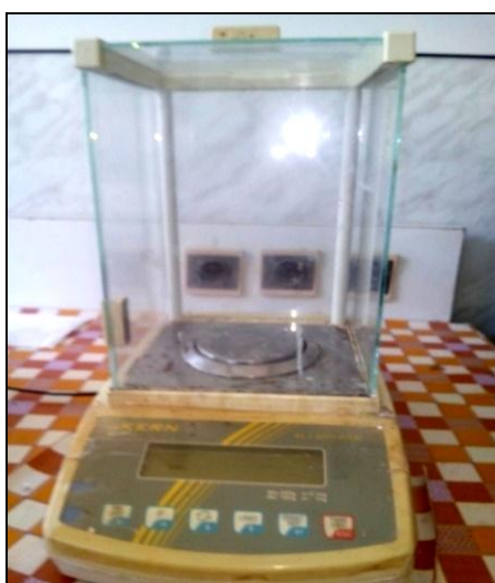
Fig. III.1. Balance électronique à verre de montre utilisée pour la pesée des réactifs de départ.
