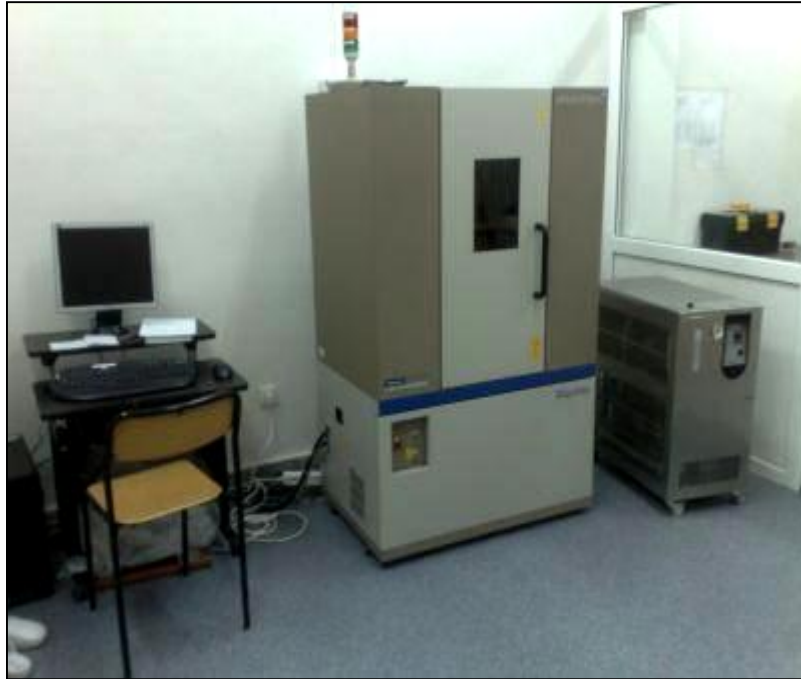
Fig. III. 9. Photographie d'un diffractomètre Rigaku du laboratoire de supraconductivité de l'université Abant İzzet Baysal de Bolu-Turquie qui permet la mesure de diffractogramme 0-2\theta par diffraction de rayons X.
