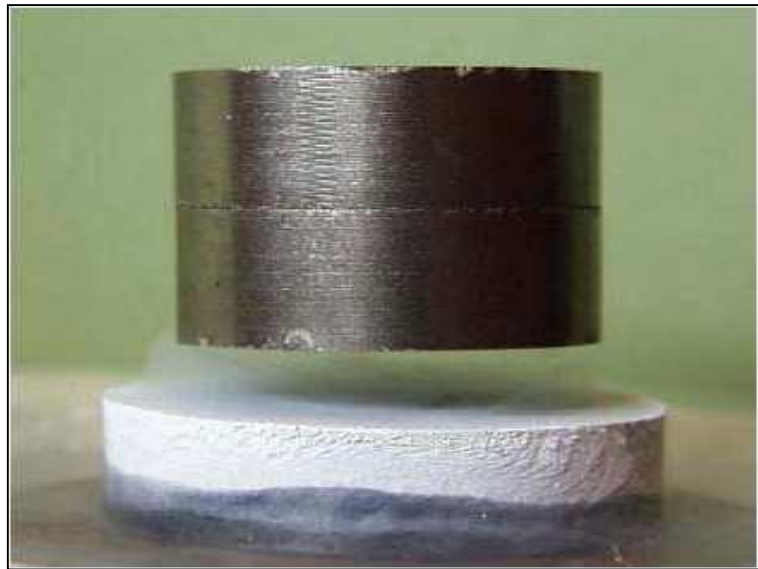
Fig I.6. Phénomène de lévitation d'un aimant au dessus d'un supraconducteur SHTC baignant dans de l'azote liquide [18].
