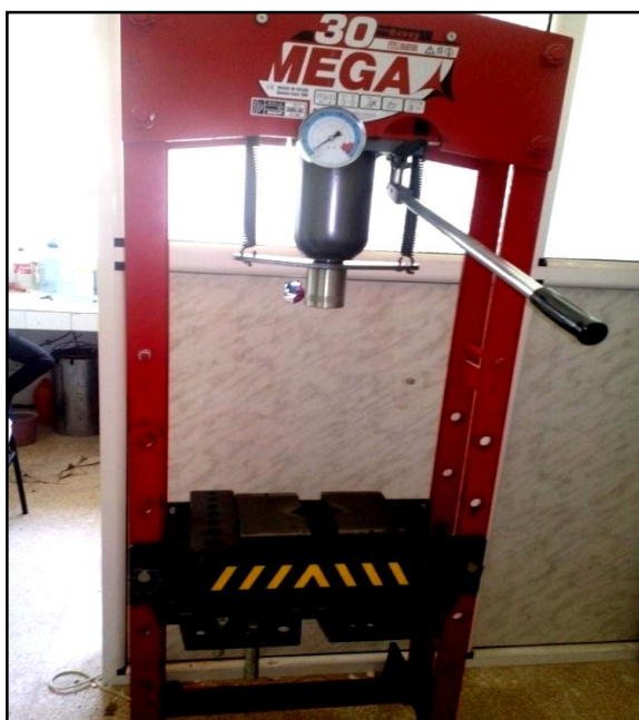
Fig.III.5 . Presse hydrostatique utilisée pour pastiller les composés \text{Bi}_2\text{Sr}_{1.6-x}\text{Zr}_x\text{La}_{0.4}\text{CuO}_{6+\delta} ( x = 0, 0.2, 0.4 ) (Laboratoire LEM – Université de Jijel).
