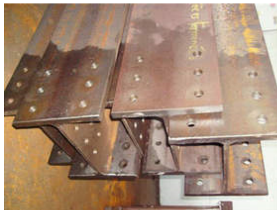
Figure.II.8 : les cintres métalliques lourds .
