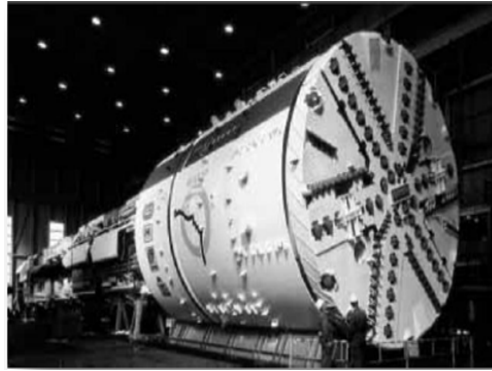
Figure II.7 : bouclier à pression boue (chantier METEOR à paris [11]).
