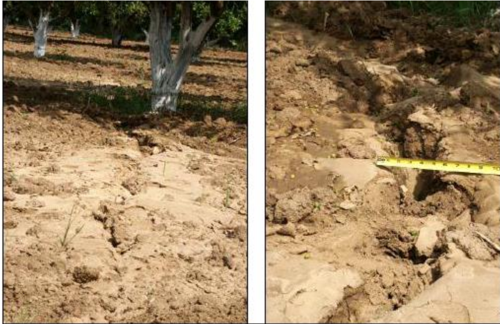
Figure I.22 Liquéfaction près de la ville de Zemmouri (ébullitions de sable) [6]
