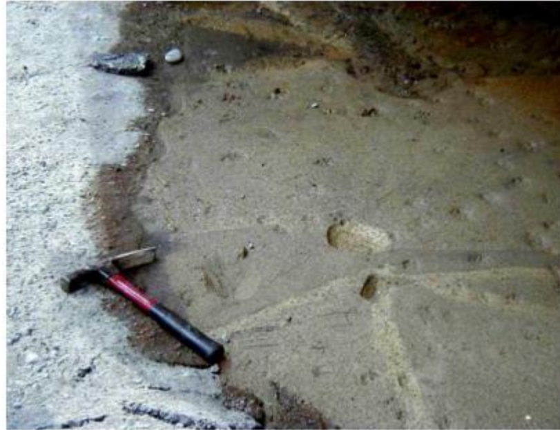
Figure I.17 Ebullition de sable en Turquie 1999
