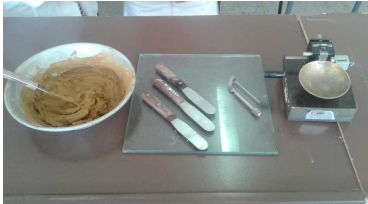
Figure III.6 : Essai de la limite de liquidité (l'appareille de Casa grande).
