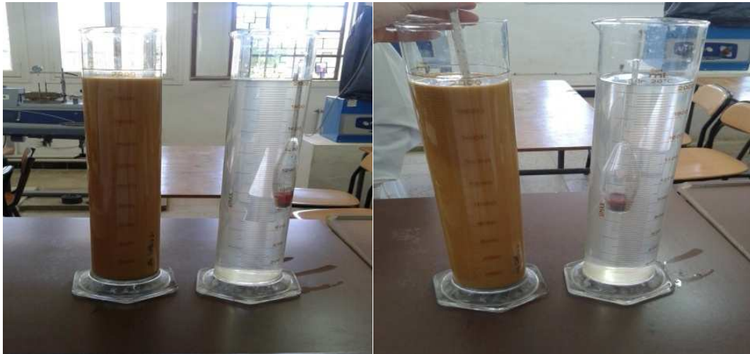
Figure III.14: Granulométrie par sédimentation.
