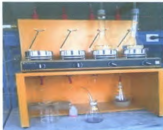
Figure 3 : La distillation de l'ammoniaque.
