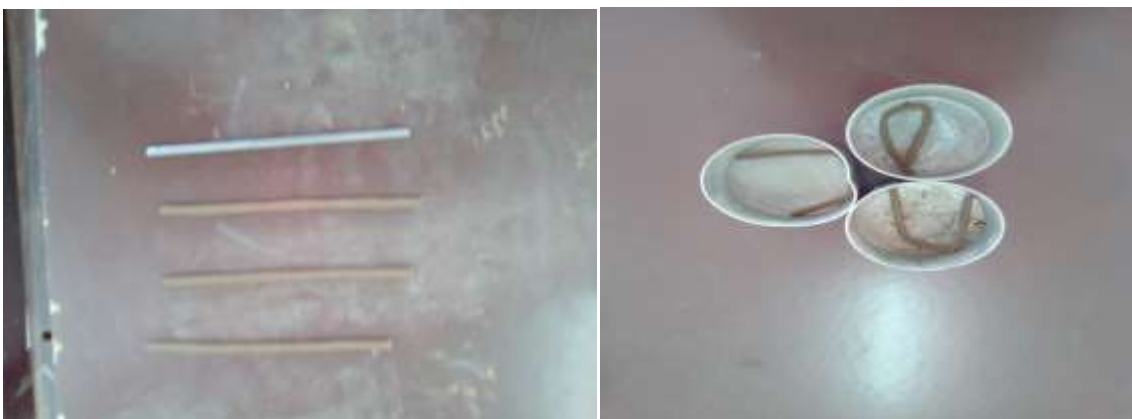
Figure III.7: Détermination de la limite de plasticité.
