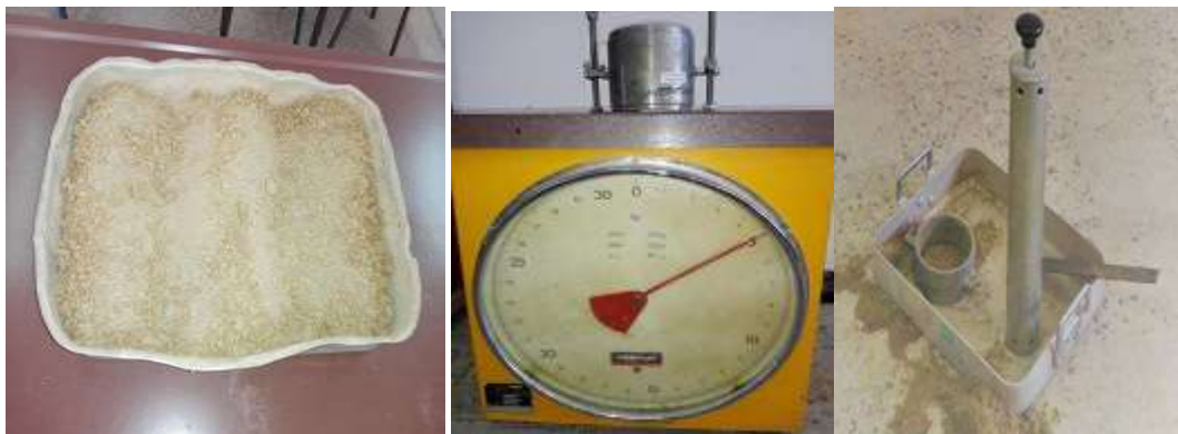
Figure III.14: Modeopératoire de l'essai Proctor
