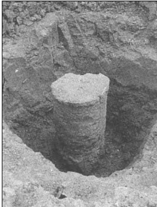
Figure I.7 : Colonne de sol traité à la chaux
