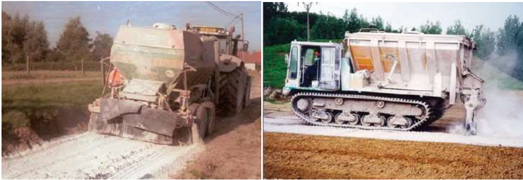
Figure II.4. Épandeur (remorqué par un tracteur, autotracteur sur chenilles).
