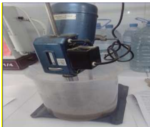
Figure III.3 : Appareillage pour essai au bleu de méthylène
