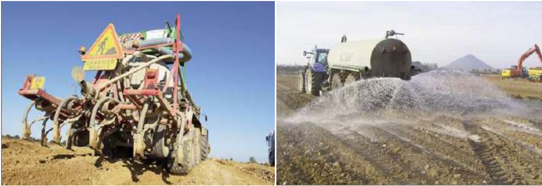
Figure II.3 : (a). Arroseuse-enfouisseuse (b). Arroseuse
