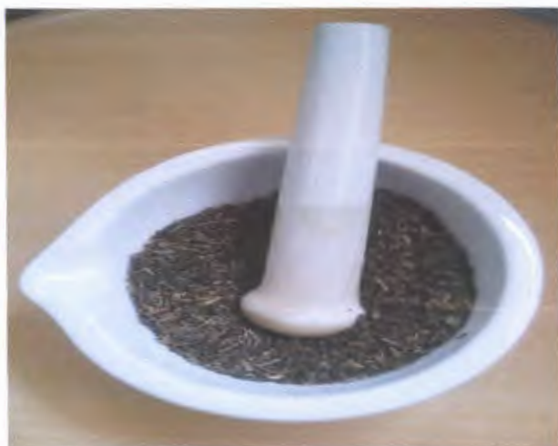
Figure 9 : Broyage par un mortier
