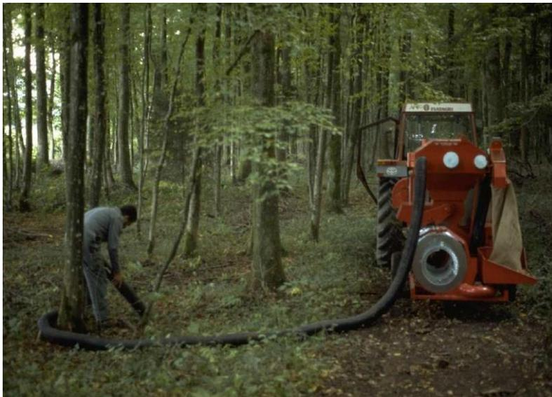
**Fig.05** : Récolte de glands mécanisée avec un aspirateur "Tonutti" (FURST, 2010)
