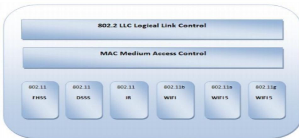
Figure 2.4: L'architecture en couches de la norme IEEE802.11[37].
