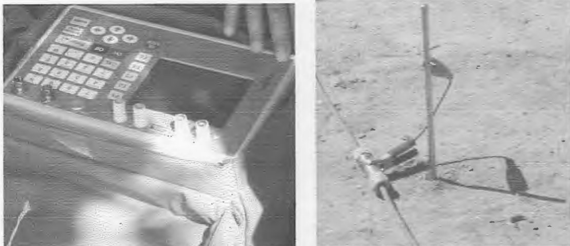
Photo IV.2 : Centrale d'acquisition: Résistivimètre (Saris/Scintrex) et Electrode de mesure du courant électrique (F. Kessasra, 2009)
