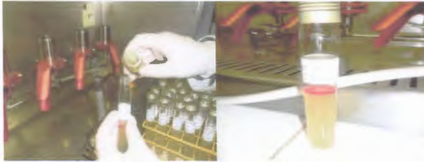
Figure 22 : Formation d'anneau rouge et production de gaz dans le tube : Présence d'E. Coli.
