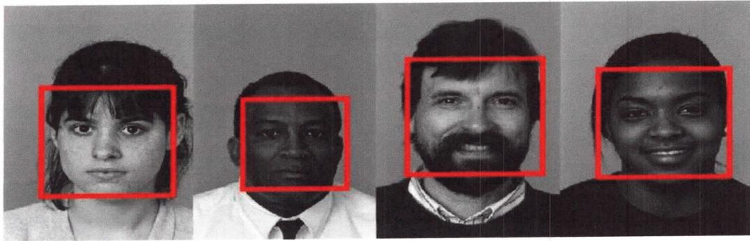
FIGURE 3.3 – Détection du Visage en utilisant la méthode Viola and Jones
