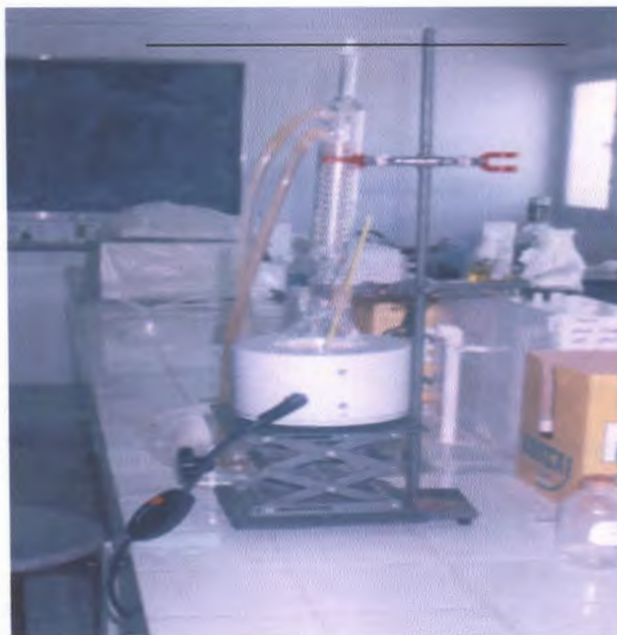
Figure : Dispositif utilisée pour la saponification.
