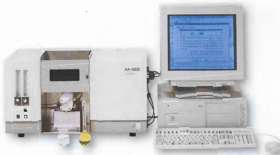
Figure 08: Spectromètre d'absorption atomique au niveau de l'université de Jijel
