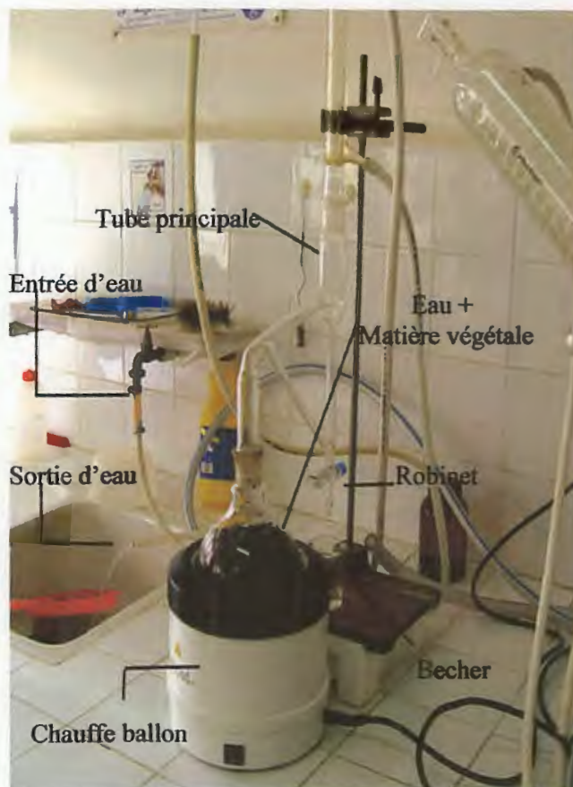
Fig.10 : Clevanger ; dispositif utilisé pour l'extraction des H.E
