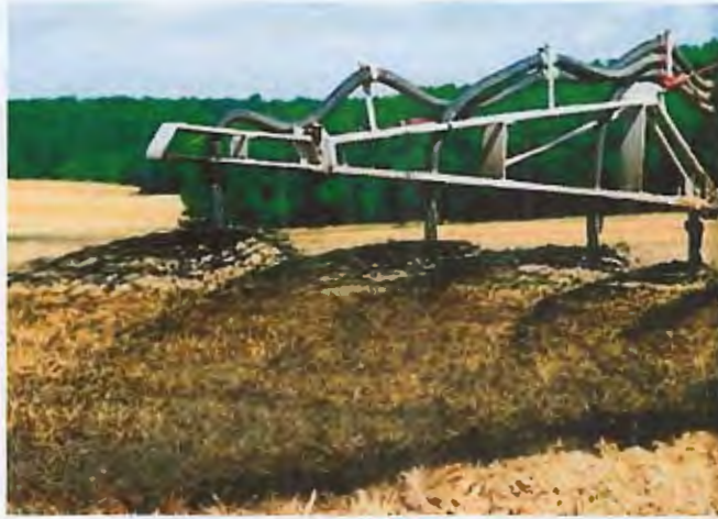
Figure 1. Epannage de boues liquides à l'aide d'une rampe adaptée.
