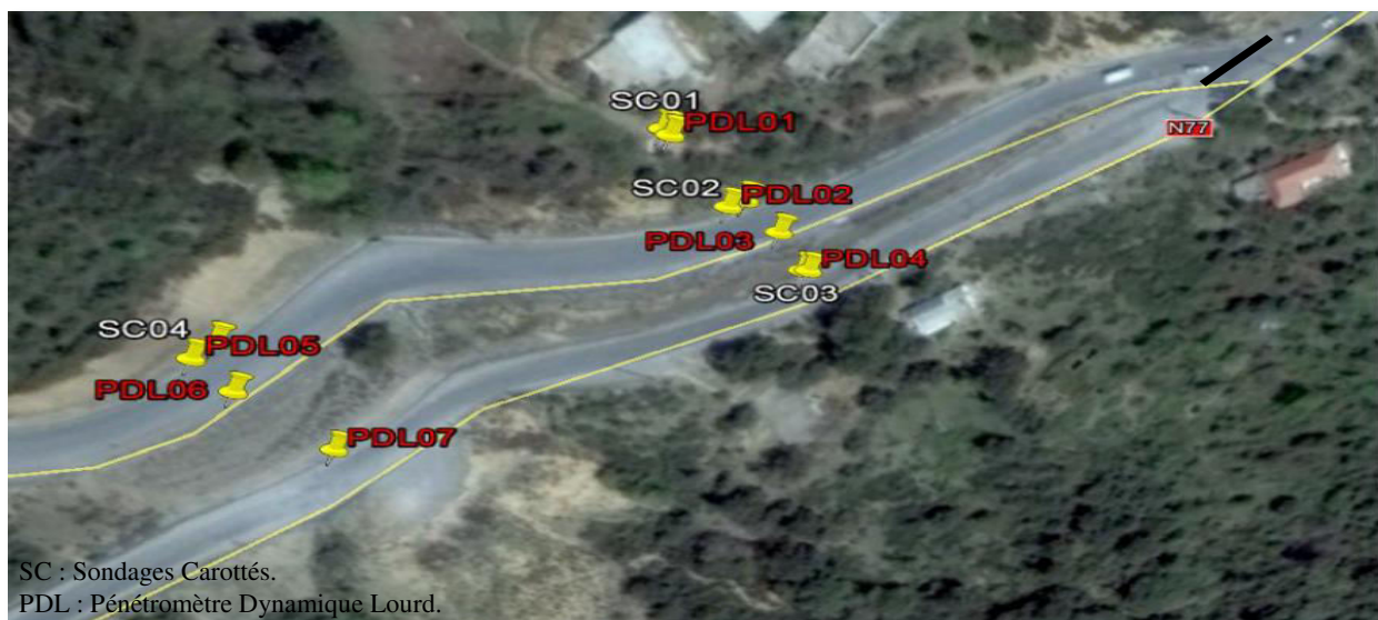
Figure.VI.4. Schéma d'implantations des essais géotechniques in situ.
