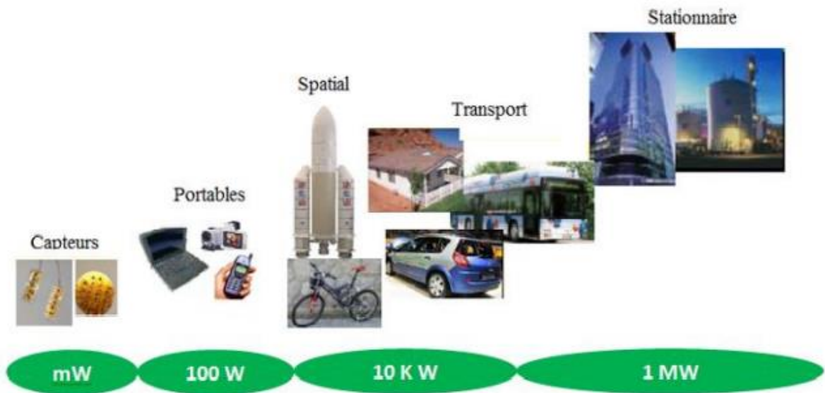
Figure I.3. Domaines d'application des piles à combustible
